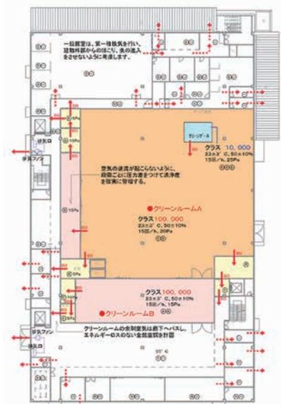
(図-4) クリーンルーム空気の流れ図
